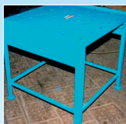
Stůl s ovládáním zasouvání jednotek pro posun a následnou fixaci břemene.
