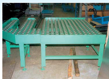
Speciální stůl pro lisovací nástroje s drážkami pro vidle paletovacího vozíku.
