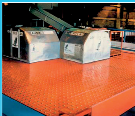
Vybavení letiště na manipulaci s AIR CARGO hliníkovými kontajnery
