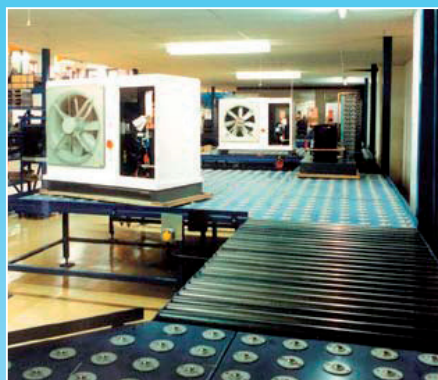
Kuličkové stoly jako součást montážní linky
